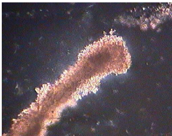
Рис. 2. Сталактиты с моста через р. Нерль, их морфология и размер, справа – шлиф, «волосовидный» агрегат, вероятно, произошло обрастание кальцитом гифа гриба или водоросли, прозрачный шлиф (николи X, размер изображения 1x1 мм).
