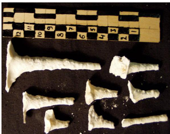
Рис. 2. Сталактиты с моста через р. Нерль, их морфология и размер, справа – шлиф, «волосовидный» агрегат, вероятно, произошло обрастание кальцитом гифа гриба или водоросли, прозрачный шлиф (николи X, размер изображения 1x1 мм).
