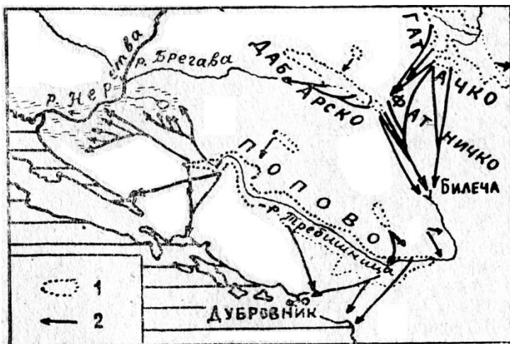
Рис. 5. Пути подземного стока карстовых вод бассейна р. Требишницы по Б. Петровичу и Б. Прелевичу [10]: 1 – контуры полей, 2 – пути стока
