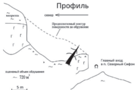
Рис. 6. Схема обрушения в привходовой зоне пещеры Северный Сифон, В.Б.Еремеев, 2014 г.
