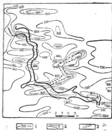
Рис. 1. План изолиний кажущегося сопротивления на участке Понимаревской пещеры (съёмка пещеры проведена В. И. Лопандиным, 1983 г.): 1 — линии равных сопротивлений, Ом·м; 2 — проекция контура пещеры на поверхность; 3 — проекция предполагаемого хода пещеры
