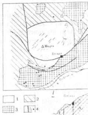
Рис. 2. Схема шахты на г. Машук (по Ф. А. Макаренко, 1951): 1 — известняки верхнего мела, 2 — мергели палеоцена, 3 — травертины, 4 — разломы и минеральные источники
