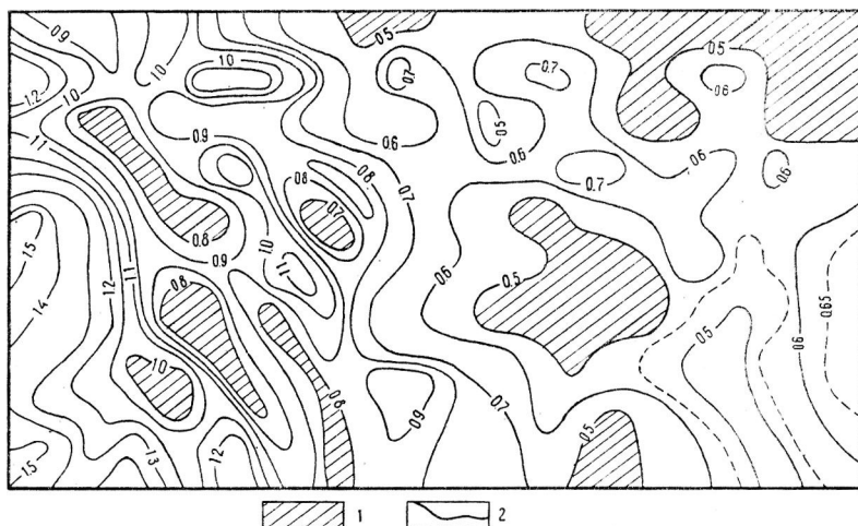
Распространение пещеристых полостей участка, прилегающего к «Старому карьеру» близ г. Губахи: 1 — зоны пород с пещеристыми полостями, выполненными продуктами карстообразования; 2 — изолинии отношений \Delta U/J
